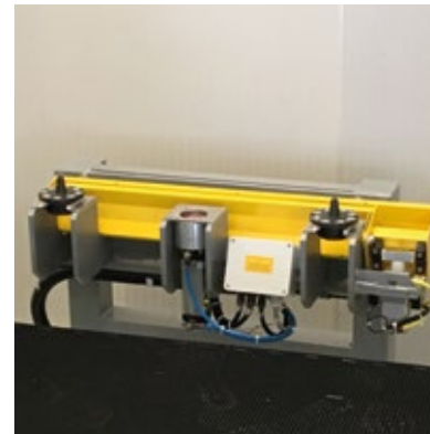
COD. A1712 MAGNETIC TOOL CHANGER CAMBIO UTENSILE MAGNETICO
